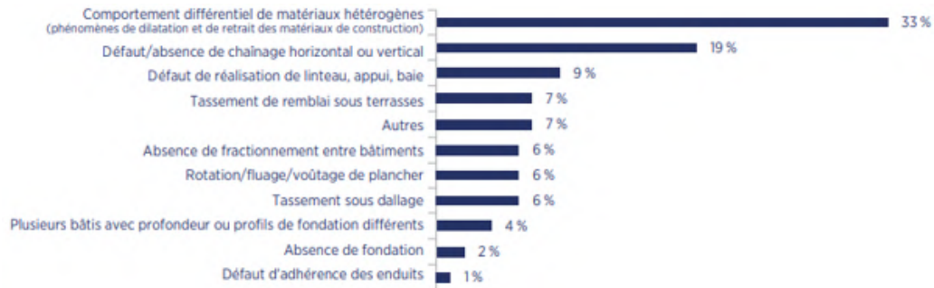
FIGURE 1.3 : Les facteurs identifiés comme expliquant des dommages mais n'étant pas des facteurs liés au RGA. Source : FFA (2022b)
