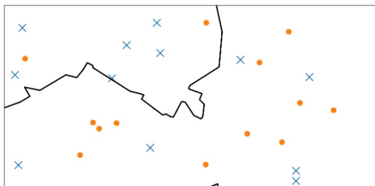
FIGURE 4.4 – Frontière de décision d'un algorithme des 5 plus proches voisins
