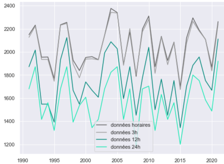
FIGURE 3.12 – Comparaison des heures d'arrêt d'une éolienne du parc n°3 aux différentes mailles temporelles de 1991 à 2021
